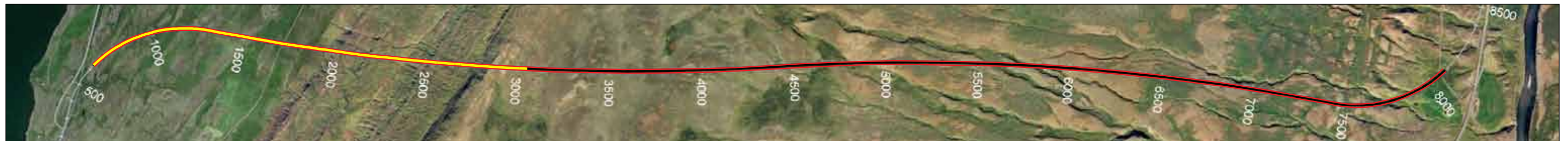
Vaðlaheiðargöng, staða framkvæmda 26. maí 2014. Búið er að sprengja 2.410 m frá Eyjafirði sem er 33,6% af heildarlengd.
